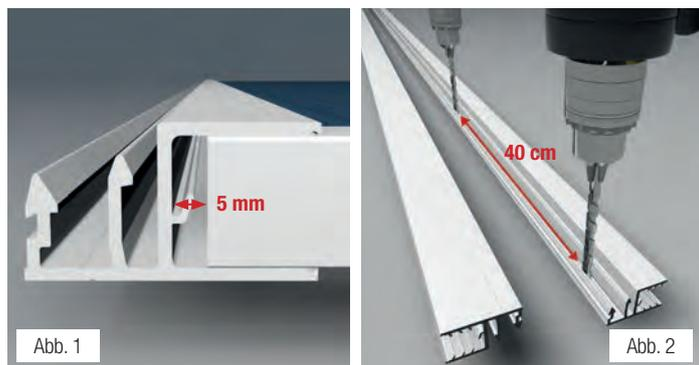
2. Die Zevener Sprosse **3** wird auf die Längsseiten der vorbereiteten Stegplatten **6** aufgestülpt. Beachten Sie bitte dabei, dass die Platte 5 mm Abstand (Abb. 1) zum Verlegeprofil behält. Achten Sie darauf, dass das Profil seitenverkehrt mit der gegenüberliegenden Seite aufgedrückt wird, damit Sie später die Profile ineinander „klippen“ können. Die Platten müssen unbedingt mit der UV-geschützten Seite nach oben verlegt werden. **(Polycarbonat hat einen einseitigen UV-Schutz)**
